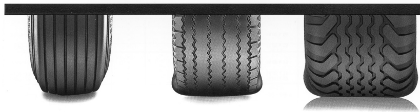
figuur 2.25 Implementbanden hebben verschillende profielen.
